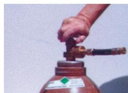
**3** Handrad vom Flaschen-Absperrventil öffnen
