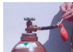
**4** Schnellverschluss und Ballon über das Ballongasventil ziehen
